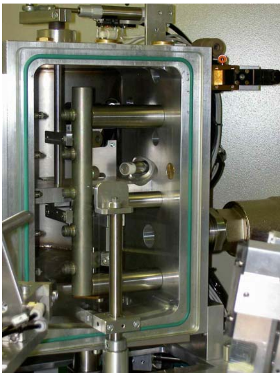
Bild 15: Anwendungsbeispiel integrale Dichtheitsprüfung im Vakuum CRI-Rail eingelegt in der Testkammer einer TLF-Dichtheitsprüfanlage
