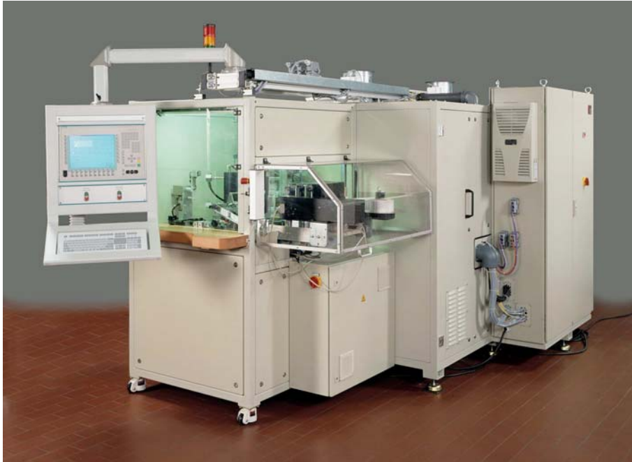
Bild 14: Anwendungsbeispiel integrale Dichtheitsprüfung im Vakuum Gesamtansicht TLF-Dichtheitsprüfanlage
